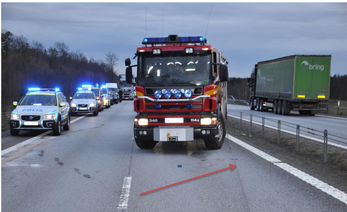
Figur 8. Olycksplatsen framför Örkelljungas släckbil med den aktuella vajern (röd pil) spänd mot bilen. Foto Stefan Sarman
